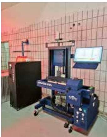
Die neue CtS-Anlage vom Typ „Spyder“ (rechts) und der UV-LED-Beleuchter „V-Light“ (links)
