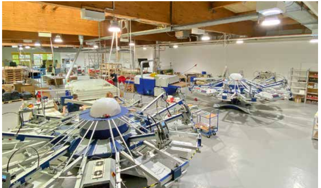
Blick in die Siebdruckhalle von Mohr Prints mit den „S-Type“-Maschinen von MHM und den „Compact“-Trocknern von Tesoma. (Fotos: Mohr Prints)
